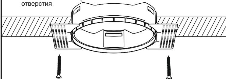
**ВАЖНО:** Установка светильника должна производиться при обесточенной электросети.
